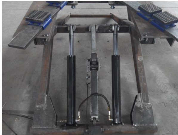
Trin 5, Montere strøm til liften og tryk på "UP" knappen indtil liften når op til 50 cm.
