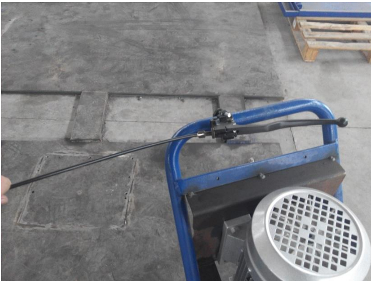
Trin 6, Montere sikkerhedslåse kablet på sikkerhedslåsen
