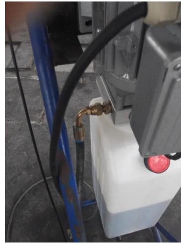
Trin 5, Montere strøm til liften og tryk på "UP" knappen indtil liften når op til 50 cm.
