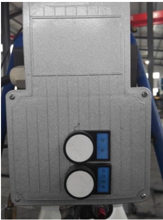
Trin 5, Montere strøm til liften og tryk på "UP" knappen indtil liften når op til 50 cm.
